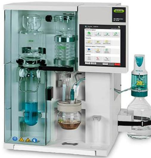
Fig.4.2.7. Kjeldhal apparatus
