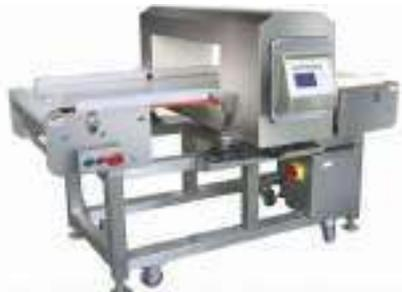
Fig. 6.2.19. Metal detector
